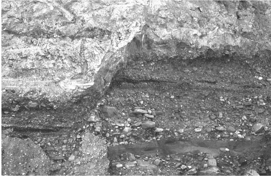
Foto: 3: Tektonische Verstellung im t3-Kies bei Halt 5
